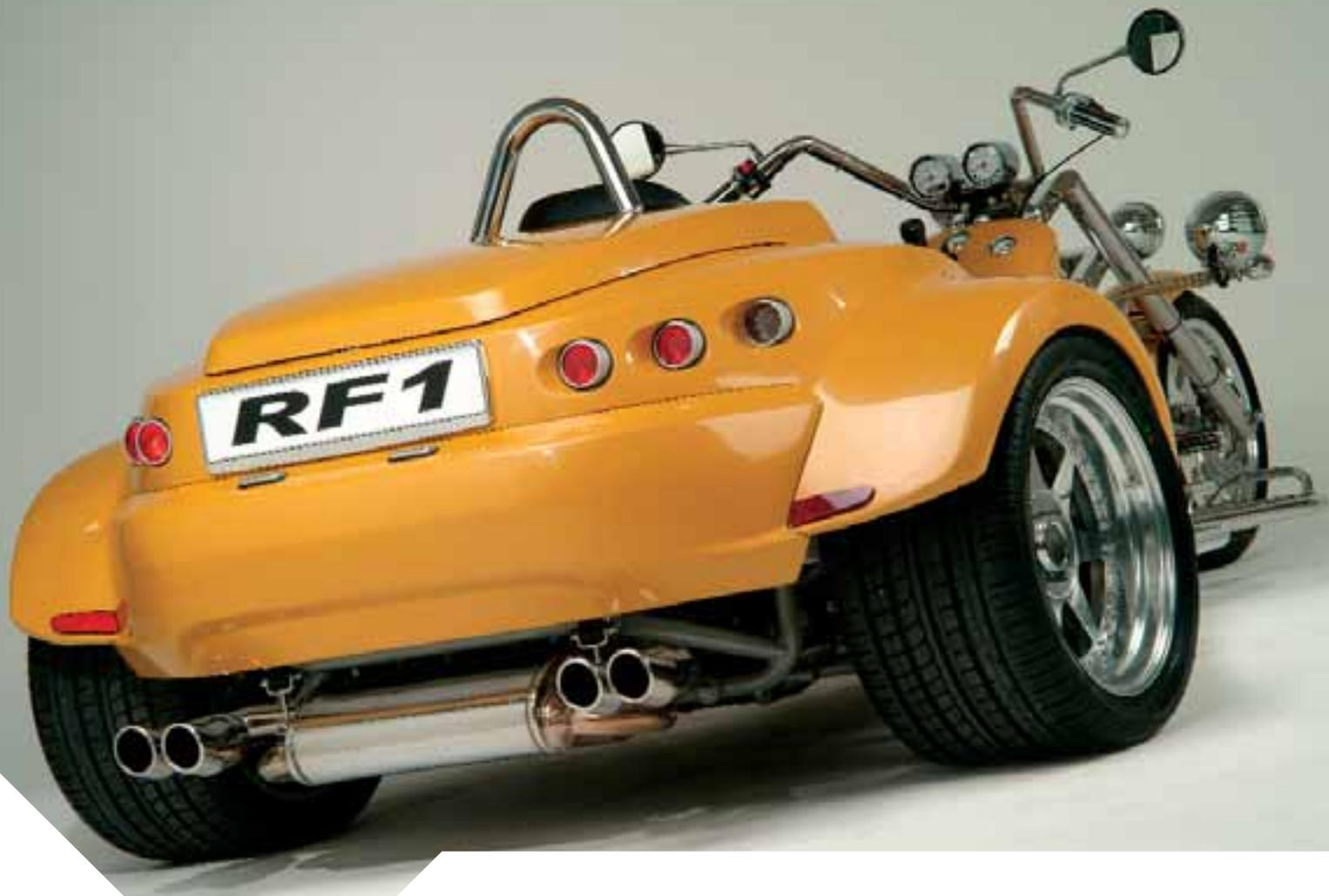
Der 4-Zylinder-Reihenmotor ist quer zur Fahrzeugachse als Mittelmotor in einem Gitterrohrrahmen eingebettet. Diese leichte und sehr verwindungssteife Rahmenkonstruktion ermöglicht es, den Fahrspaß dieses leistungsstarken Trikes zu genießen. Der volle und sonore Klang der Edelstahlauspuffanlage und das tiefe
