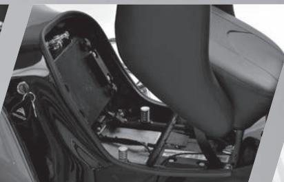
Klappbarer Fahrersitz / Zugang zu den Sicherungen
